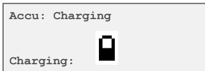
バッテリーが完全に充電されると、機器の電源が自動的に切れます。充電が完了する前に機器を使用したい場合は、フロントパネルのオン/オフスイッチを押すことで、いつでも通常の動作モードを再開することができます。背面パネルの主電源をオフにすると、充電が中断されます。
